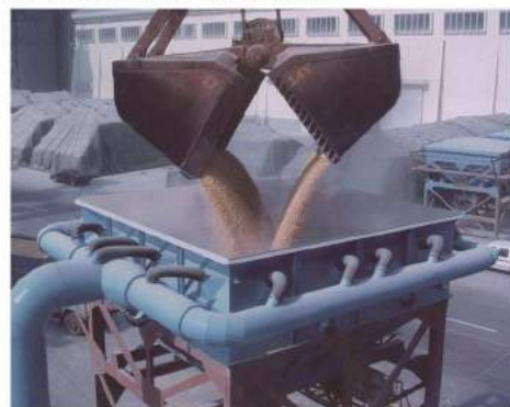
印尼客户35m³固定式除尘漏斗 (物料：煤炭、黄沙)
