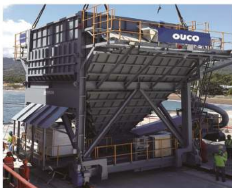
越南客户70m³皮带机式除尘漏斗 (物料：水泥熟料)
