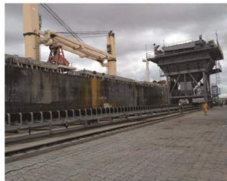
智利客户50m³轨道自行式移动除尘漏斗 (物料：玉米、小麦、大豆、菜籽)
