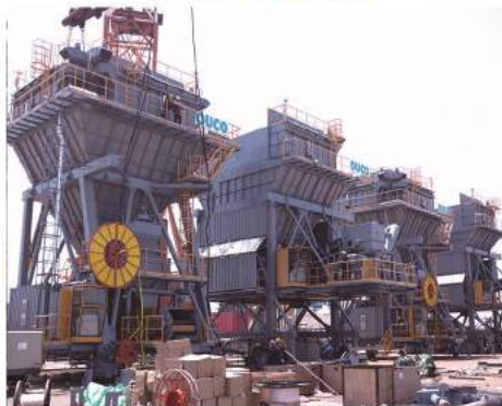
菲律宾客户自行走70m³移动漏斗 (物料：水泥熟料)
