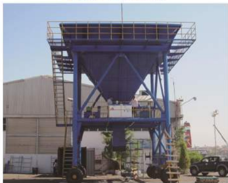
约旦客户35m³轮胎牵引式移动漏斗 (物料：散杂物料)
