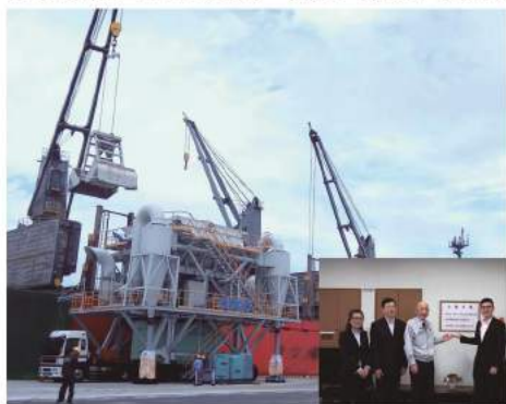
日本客户40m³轮胎牵引旋风除尘漏斗 (物料：棕榈壳)
